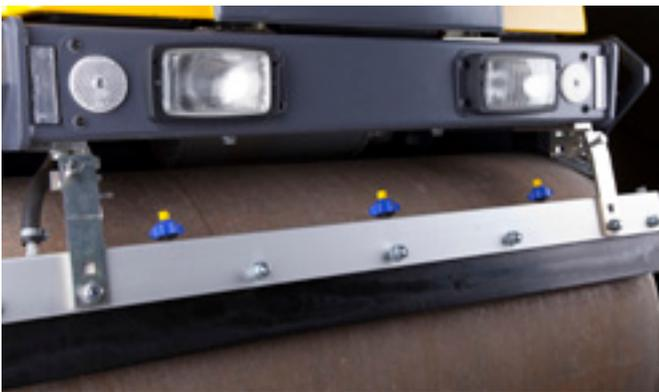
Système d'arrosage pressurisé alimenté par une pompe de haute capacité avec rampes et buses d'arrosage auto-drainantes.
