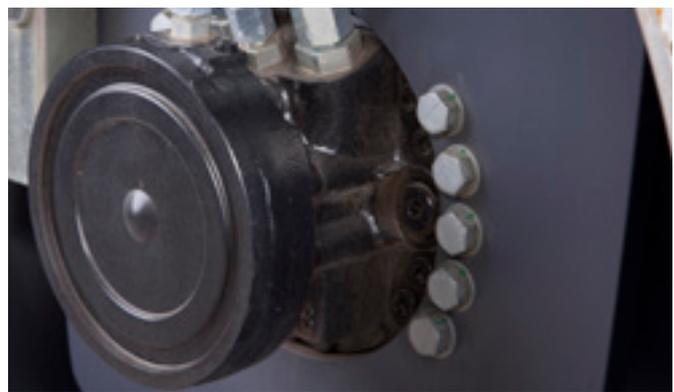
Tous les rouleaux sont équipés de freins auto-serrants sur les cylindres (ou sur le cylindre et les roues). Les freins se serrent automatiquement en cas de défaillance du moteur, du système hydraulique ou du circuit électrique.
