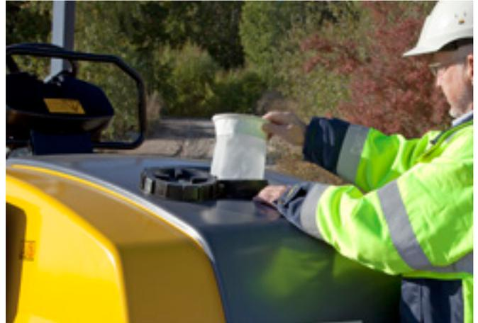
Réservoir d'eau avec orifice de grand diamètre afin de faciliter le remplissage.
