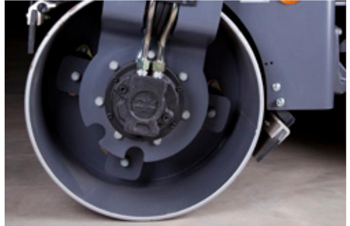
Cylindres de grand diamètre pour faciliter le compactage, même sur les enrobés instables. Cylindre épais pour prolonger la durée de vie.
