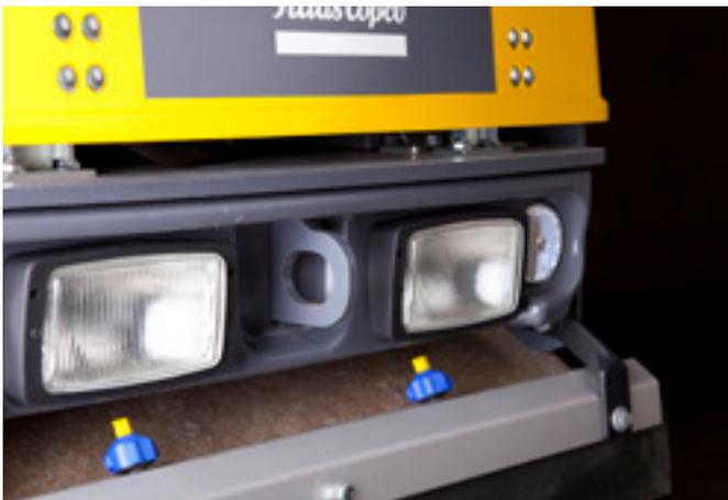
Système d'arrosage pressurisé alimenté par une pompe de haute capacité avec rampes et buses d'arrosage auto-drainantes.
