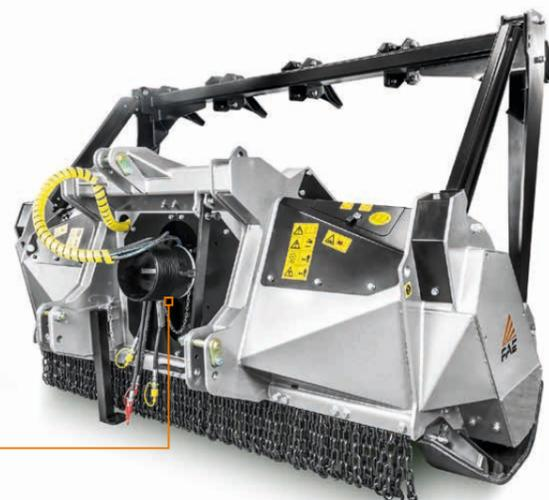
Système de réglage automatique du parallélisme du boîtier-cardan type Z maintient toujours un angle de travail correct entre le cardan et les prises de force
