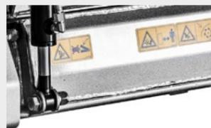
**Capot avant à réglage hydraulique**
