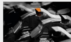
**Vaste choix d'outils spéciaux**, boulonnés avec des plaquettes en Widia® anti-usure, interchangeables et adaptés à différentes applications
