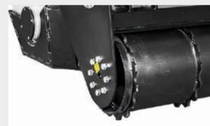
**Rouleau de support à réglage hydraulique**
