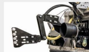
**Système d'alignement réglable du boîtier-cardan type W**
