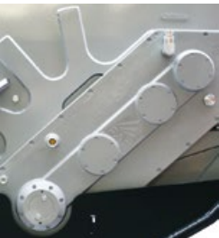
Double transmission à engrenages diminue la vitesse du rotor en réduisant l'usure des outils
