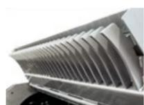
**Grille vissée sur le capot** permet le réglage de la granulométrie du matériau en sortie
