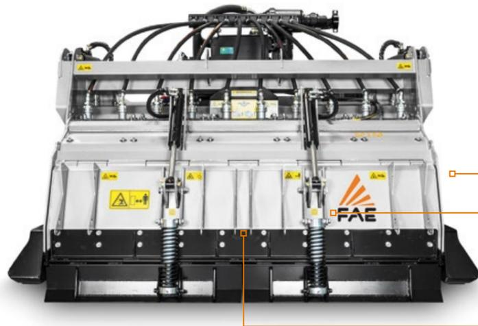
Capot arrière à réglage hydraulique
