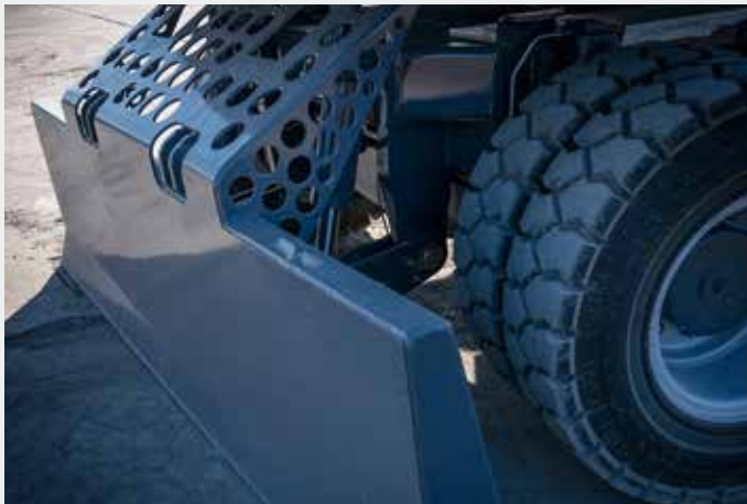
• Lame d'appui avec protection de cylindre intégrée
