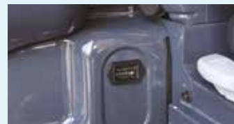
Horamètre visible depuis l'extérieur
