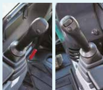
Commande proportionnelle au manipulateur (option) Circuit hydraulique auxiliaire pilotable proportionnellement au manipulateur.
