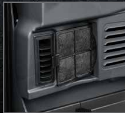
Filtre de recyclage d'air de la cabine
