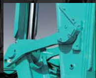
Capteur d'angle des biellettes
