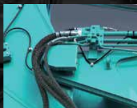
Capteur d'angle du balancier
