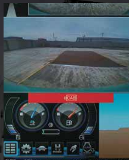
Alarme du système anticollision
