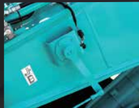
Capteur d'angle de la flèche principale
