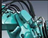
Capteur d'angle de la flèche intermédiaire
