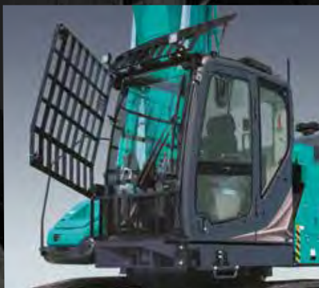
Vitres frontales et supérieures faciles à nettoyer grâce au système d'ouverture des grilles sans outil et à la passerelle avant.
