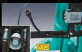
Mégaphone Le chauffeur peut alerter les collègues environnants sans quitter les commandes de la machine.
