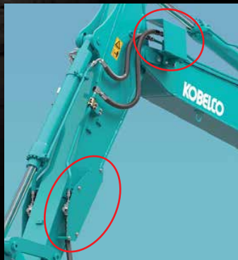
Protection des coupleurs hydrauliques du balancier et de la flèche
