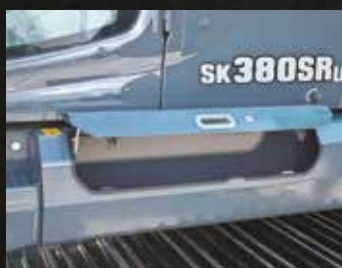
Large compartiment de rangement accessible depuis le sol
