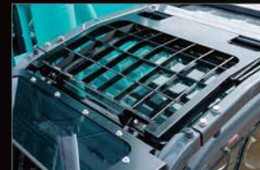
Protection de toit basculable de série
