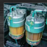
Préfiltres à carburant avec décanteur d'eau
