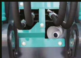
Protection frontale du pied de flèche
