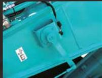
Capteur d'angle de la flèche principale
