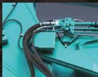
Capteur d'angle du balancier
