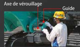
Côté inférieur : Les axes de verrouillage sont suspendus et guidés à hauteur d'homme.
