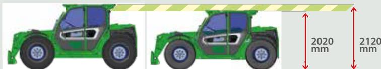
Les élévateurs télescopiques TF30.9 et TF33.7 sont également disponibles dans la version Cabine Basse « Low Profile », ce qui permet de réduire la hauteur de la machine de 10 cm, sans compromettre les dimensions internes de la cabine et le confort de l'opérateur. Optimisée pour des travaux dans des environnements de hauteur limitée tels que les fermes avicoles, les parkings souterrains, les mines.
