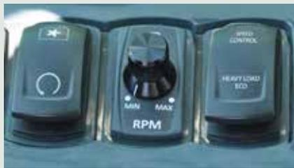
Pour finir, EPD comprend le contrôle du régime du moteur proportionnellement à l'utilisation du joystick (plus l'inclinaison du joystick est grande, plus le régime du moteur est élevé). Fonctionnalité optimisée pour la manutention de matériaux.
