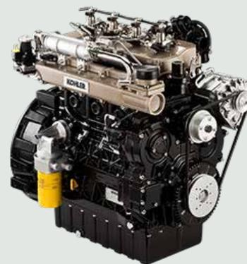
Les modèles P27.6 sont équipés d'un nouveau moteur KOHLER KDI2504TCR de 2 500 cc à quatre cylindres de 75 CV (55 kW). Le moteur est conforme aux réglementations anti-pollution Stage V par système DOC (Diesel Oxidation Catalyst) et DPF (Diesel Particulate Filter).
