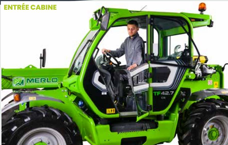
Accès simple et facile à la cabine garanti par la porte qui peut être ouverte à 180°, en mesure de maximiser l'espace d'entrée, et par la grande distance entre le montant et le volant. La vitre latérale, indépendante du corps de la porte, peut être bloquée en position ouverte afin de maximiser l'échange d'air, la visibilité et le contact direct avec ceux qui travaillent à l'extérieur, à proximité de la machine.
