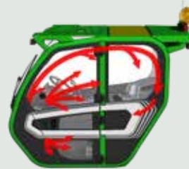
Développée selon les normes automobiles, elle réduit de moitié les temps de préchauffage et de refroidissement par rapport à un système de climatisation classique. La buse d'aspiration est placée sur la porte latérale, à l'écart des émissions potentielles de poussière et d'impureté. À l'intérieur se trouvent 8 buses, dont trois dédiées au dégivrage du pare-brise, pour un confort climatique optimal.
