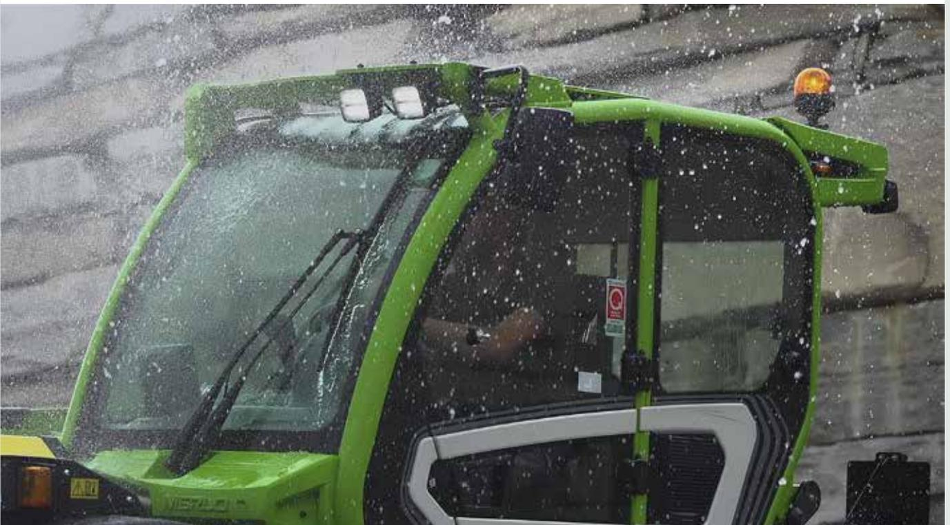
La cabine Merlo est équipée de série de trois brosses pour nettoyer les vitres. Une frontale, pour nettoyer le pare-brise, gérable avec une double vitesse en fonction du volume de pluie. Une supérieure pour nettoyer le toit en verre, et pour finir une arrière pour nettoyer la lunette.
