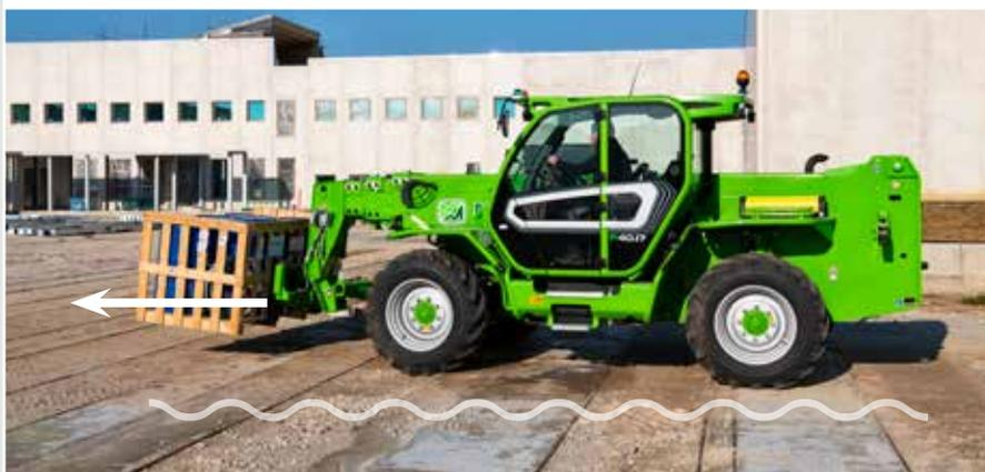
La suspension active de la flèche (BSS) est disponible en option. Ce système protège la charge pendant les déplacements et maintient un confort de conduite élevé sur les terrains accidentés. La suspension est automatiquement désactivée à vitesse réduite (inférieure à 3 km/h), ce qui offre une précision et une force de manutention maximales.
