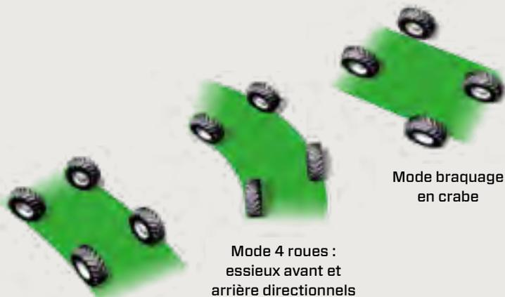
Mode 2 roues : essieu directionnel avant
