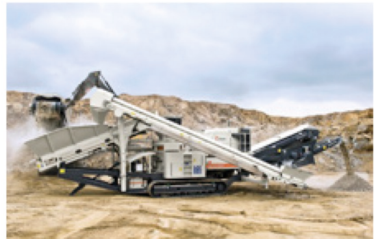
Le Lokotrack® LT200HPS™ peut être équipé de cribles détachables à un ou deux étages.
