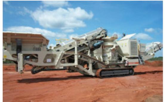
Le Lokotrack LT300HP est disponible avec un alimentateur à courroie ou un scalpeur vibrant.
