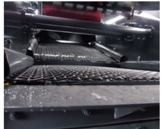
Le crible à double pente permet une séparation efficace et précise des matériaux.
