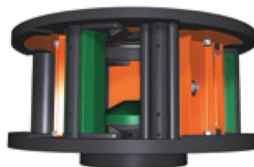
Le nouveau rotor orange de Metso est une solution facile et rentable pour les broyeurs à percussion à axe vertical. La disponibilité de la machine est accrue grâce à la réduction de la durée des opérations de maintenance, et à une durée de vie des pièces d'usure augmentée.
