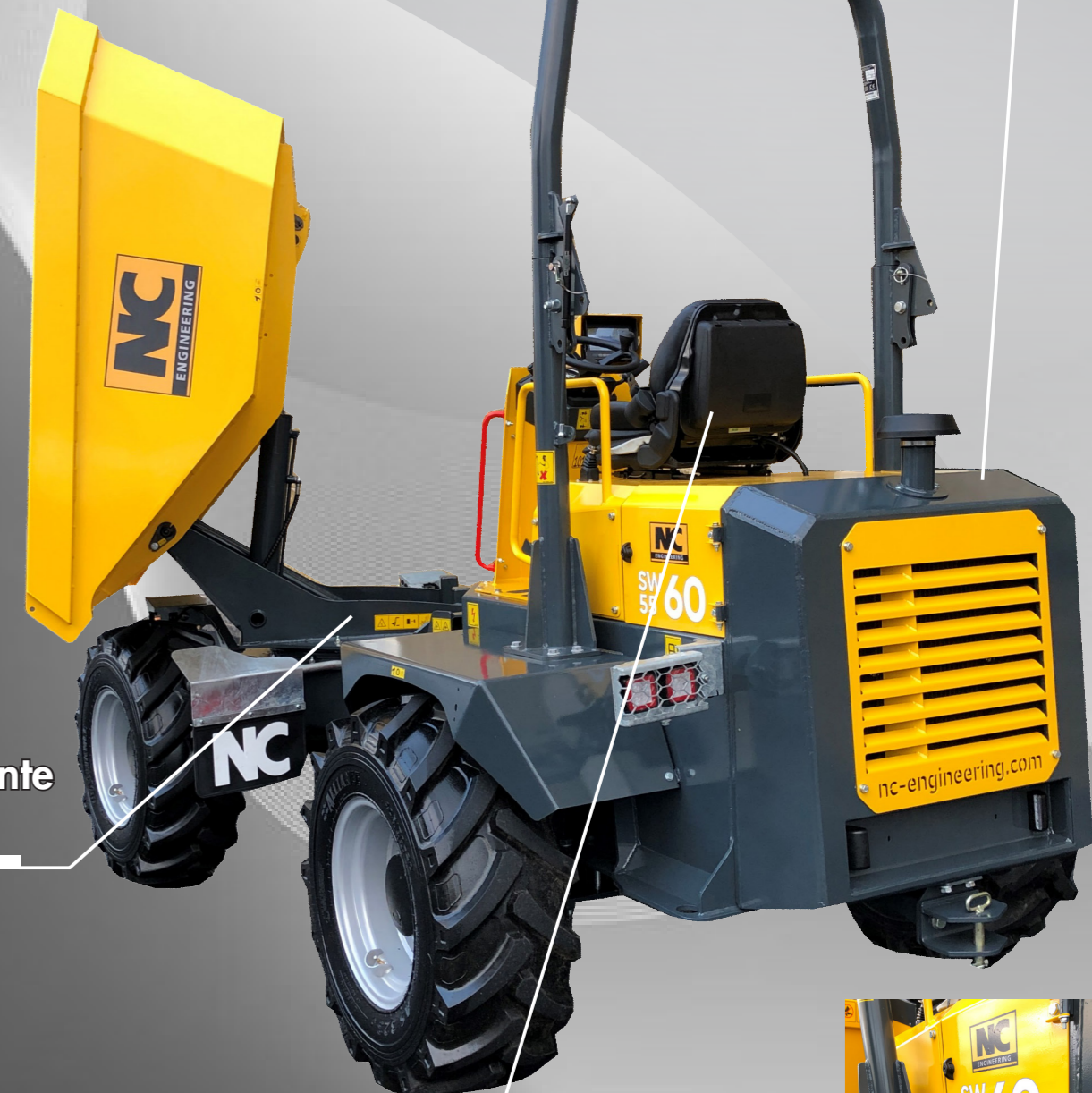
Siège suspendu réglable avec ceinture de sécurité à enrouleur et boîte à documents
