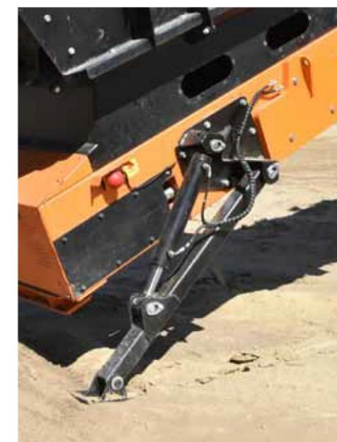
Supports hydrauliques (en option) à l'arrière du convoyeur
