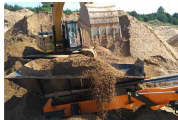
La haute durabilité du convoyeur permet l'utilisation de la trémie directe de 8m<sup>3</sup> sans modifications supplémentaires au convoyeur
