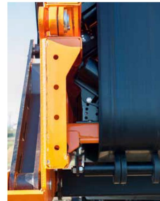
Possibilité de changer l'angle des rouleaux supportant la bande afin de former un flux de matériau transféré (changer le profil de la bande)
