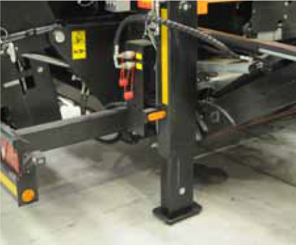
Les pieds hydrauliques assurent une stabilité accrue et une sécurité et un confort d'utilisation
