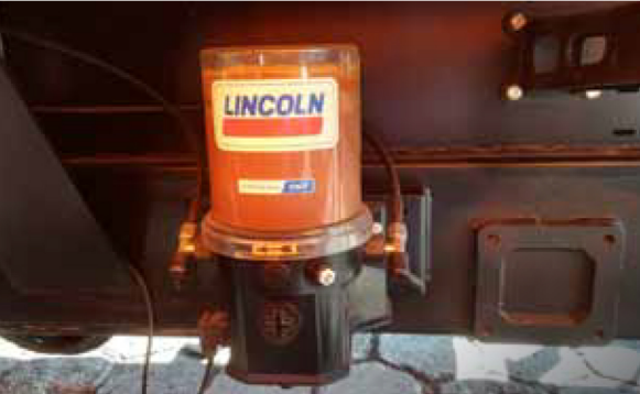
La pompe de graissage centrale garantit une lubrification continue des éléments de la machine qui l'exigent (disponible en 2 formats)
