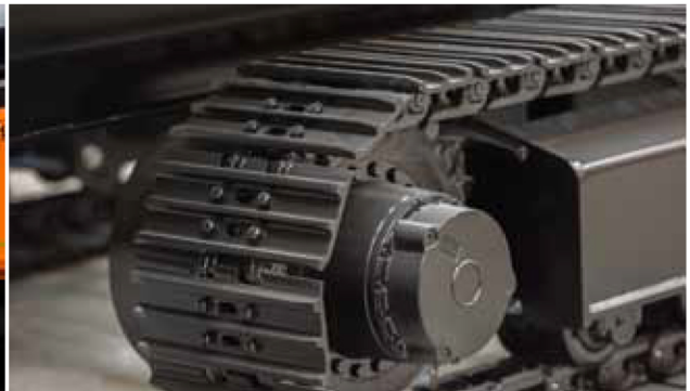
Les chenilles assurent à la machine une meilleure stabilité et facilitent son déplacement
