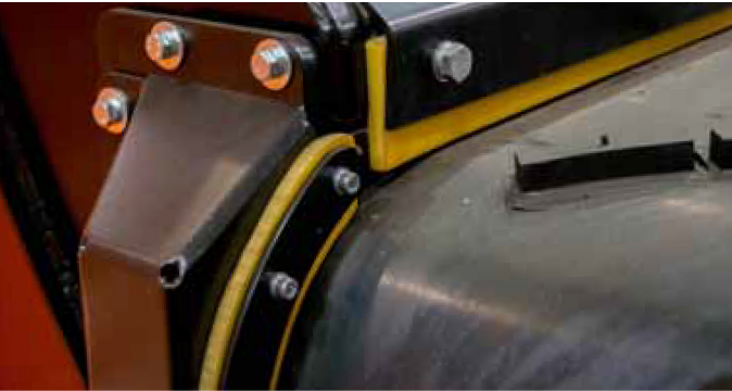
Isolation renforcée de la trémie pour éviter l'accumulation de matériau dans la zone interne de la machine
