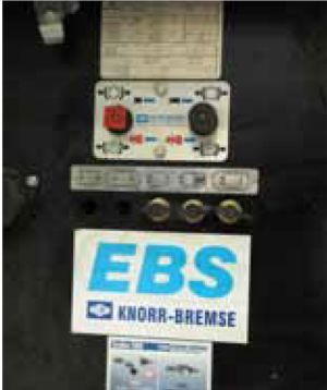
Système de freinage EBS et homologation permettant de circuler jusqu'à 100km/h sur la voie publique
