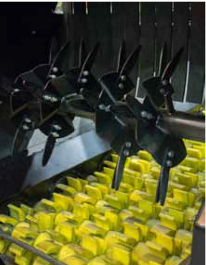
L'arbre à lames va répartir de manière homogène la matière à cribler
