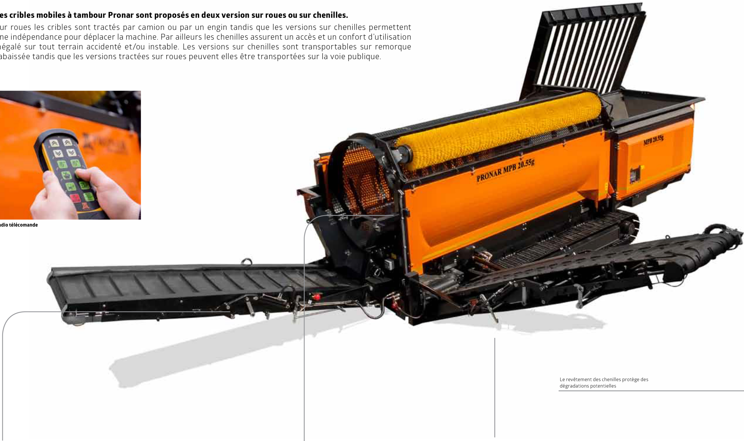
La bande de transport latérale se rabat sur le côté de la machine et réduit ainsi la hauteur pour le transport
