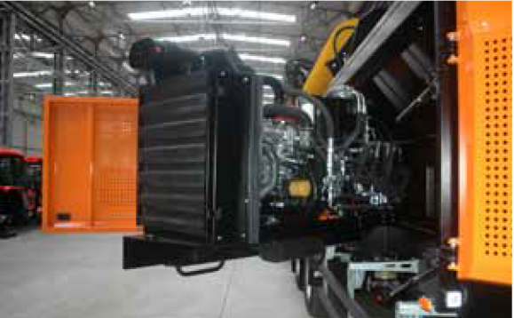
Le moteur et le système hydraulique sont montés sur un chassis basculant pour un accès rapide et facile pour les opérations de maintenance
