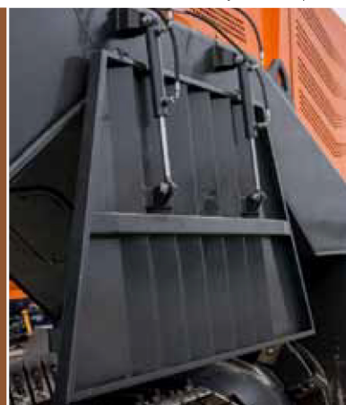
L'aile arrière amovible limite les rejets de compost
