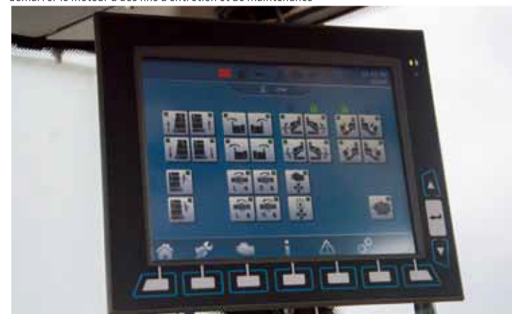
L'alimentation en mode veille permet d'allumer et faire fonctionner la machine sans devoir démarrer le moteur à des fins d'entretien et de maintenance
