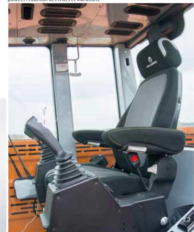
Afin d'assurer un confort optimal à l'opérateur au sein de la cabine, le fauteuil dispose d'une suspension pneumatique avec positionnement automatique, régulation du poids et réduction des chocs et vibrations
