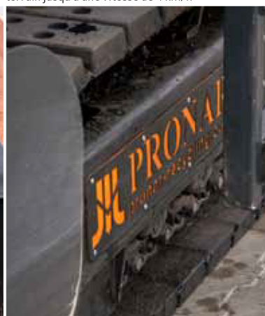
L'entraînement hydraulique sur chenilles permet de manoeuvrer aisément sur tout types de terrain jusqu'à une vitesse de 4 km/h
