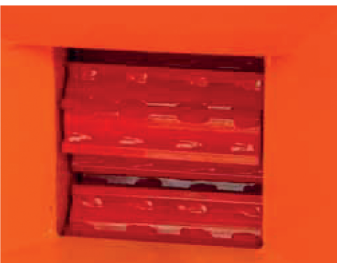
Rouleaux acheminant la matière vers le jeu de couteaux de déchiqetage
