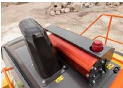
Système de remplissage rapide de carburant
