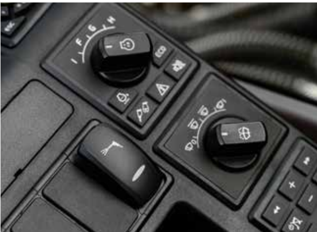
Système d'élimination des poussières - Mode sélectionnable auto/manuel
