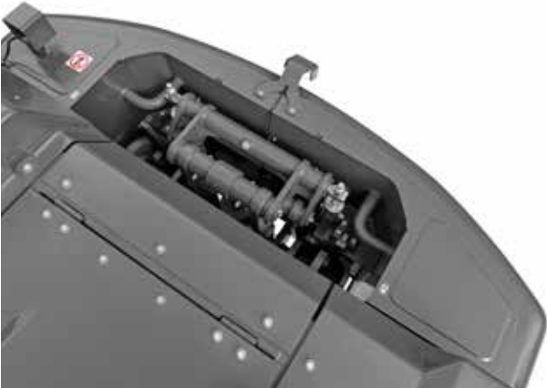
Système d'élimination des poussières - Mode sélectionnable auto/manuel
