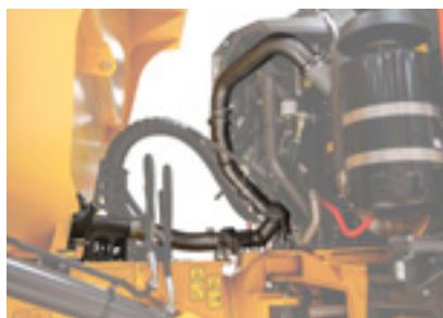
Chauffage de la benne par l'échappement
